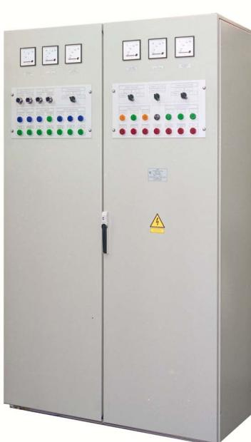
Шкаф собственных нужд имеет возможность подключения к трем вводам: двум – от трансформаторов собственных нужд и одному городскому вводу 0,4 кВ. Шкаф оснащен АВР в случае исчезновения питания на каком-либо вводе. Учет активной энергии, расходуемой на отопление подстанции, ведется современными цифровыми четырехзонными счетчиками.
